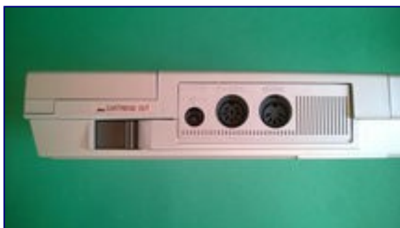
Tylna ścianka: Dźwignia usunięcia magnetofonu, zasilanie (6V) i interfejsy szeregowo (5V RS-232 i szybki interfejs zgodny z MSX do podłączenia takich urządzeń jak zewnętrzna drukarka czy stacja dysków).
