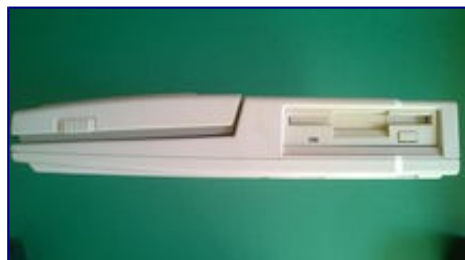
Prawa strona: Stacja dysków. Warto zwrócić uwagę, że kształty są podobne jak u poprzedników, ale jednak dużo bardziej opływowe. Obudowa jest również o ponad 1/3 niższa.
