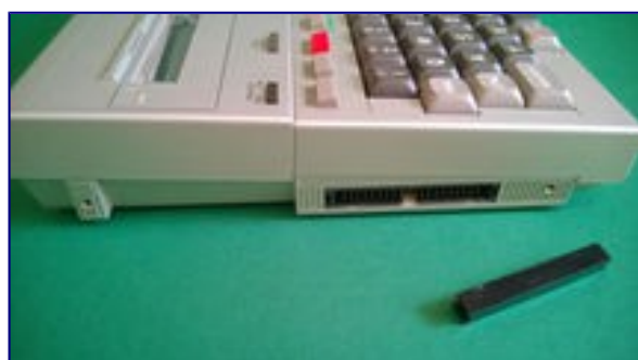
Lewa strona: Złącze modułu dodatkowej pamięci RAM.
