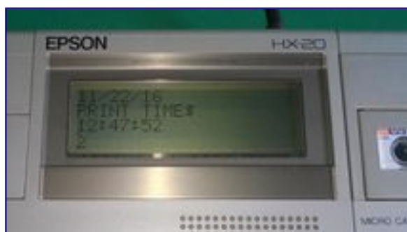
Zbliżenie ekranu. Tak. Komputer ma zegar i kalendarz. Warto też wspomnieć, że "wbudowany" magnetofon można było obsługiwać całkowicie z poziomu języka Basic (łącznie z przewijaniem taśmy i dostępem do wskazania licznika).
