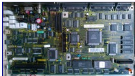
Płyta główna. W górnej lewej części znajduje się blok zasilania.
