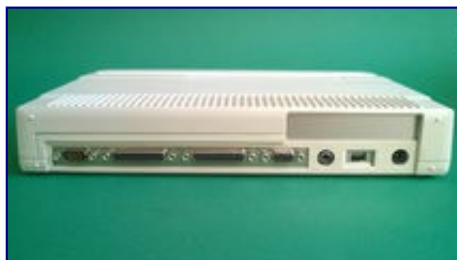
Widok od tyłu. Interfejsy, włącznik i zaślepka modemu.
