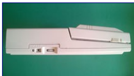
Lewa strona: Reset, wybór trybu pracy stacji dysków, kontrast ekranu
