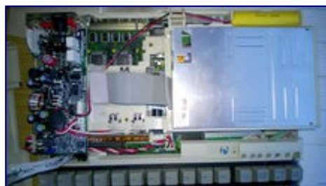
Wnętrze. Po lewej zasilacz. Pod nim znajduje się kontroler twardego dysku. Po prawej stacja dysków i (pod nią) twardy dysk.
