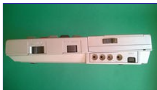
Prawa strona: Włącznik, "kontrast" ekranu, gniazda zewnętrznego magnetofonu (ze sterowaniem)... i gniazdo czytnika kodów kreskowych.
