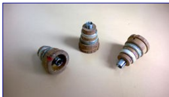
Tekstolitowe oświetlacze. Pierścienie zasilające są zupełnie luźne. Producent nie przewidział lutowania przewodów do pierścieni.
