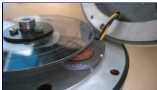
Wnętrze. Tu widać tekstolitową oprawę fotoelementów i otwory na mocujące ją gwintowane kołki.
