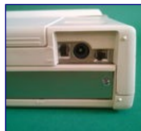
Zbliżenie włączników (od prawej): Włącznik zasilania, gniazdo zasilania i oddzielny włącznik zasilania twardego dysku.
