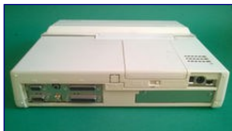
Widok od tyłu: Po lewej interfejsy, po prawej włączniki. Widać również zaślepkę gniazda telefonicznego modemu i zaślepkę złącza rozszerzeń.
