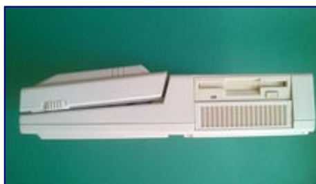
Prawa strona: Stacja dysków. Warto zwrócić uwagę na zgrubienie ekranu kryjące układ podświetlenia. To prawie centymetr grubości(!).
