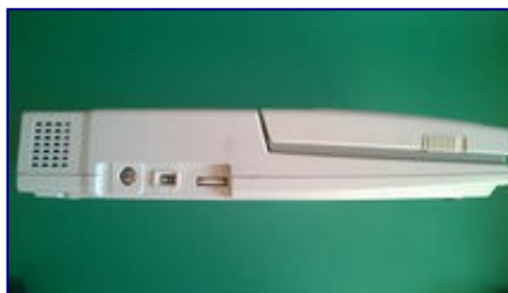
Lewa strona: Gniazdo klawiatury numerycznej, tryb pracy stacji dysków, kontrast ekranu.
