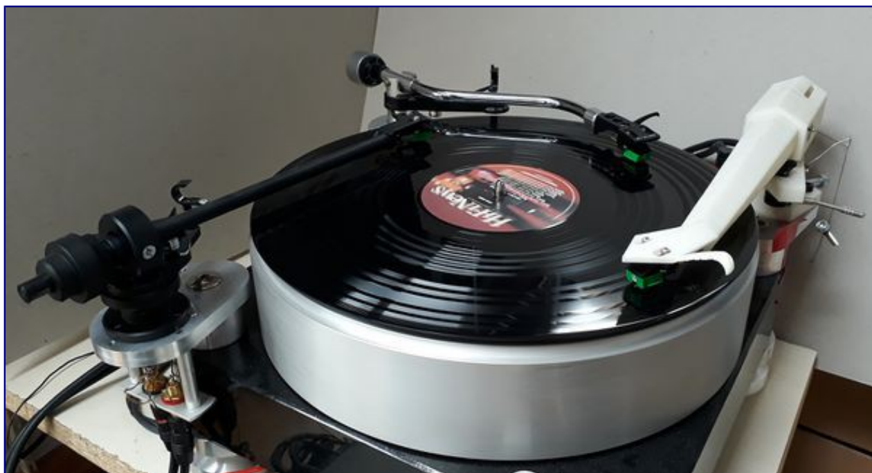
Rys.1. Ramiona zamontowane do gramofonu. Ariston – po lewej na górze, Linn – po prawej i nasze DIY na dole.
